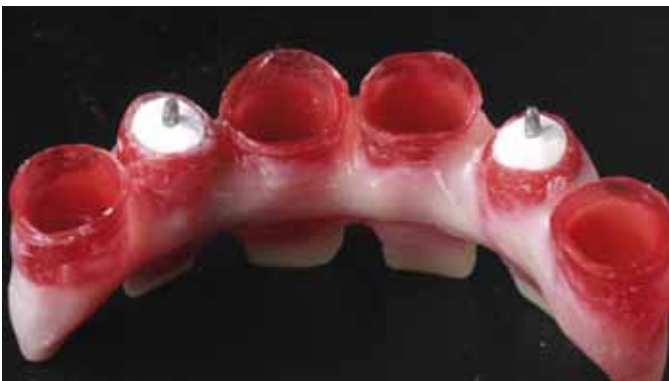
Abb. 85 und 86 Das abgenommene Frontzahnbrückengerüst von basal. Im Bereich der Brückenglieder ist der ummantelte EBM-Kern zu sehen. Der Wolframdraht stabilisiert den Kern beim Einbetten. Zudem dient der als Fixierung auf dem Modell und verhindert ein Abbrechen des Einbettmassekerns beim Gießen
