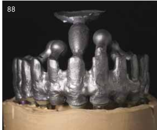
Abb. 87 bis 89 Die nach der Sabath-Technik angestifteten und gegossenen Gerüste, passen nach dem Ausstrahlen der EBM-Kerne und wenigen Schleifkorrekturen spannungsfrei auf das Modell – der Randschluss stellt sich optimal dar
