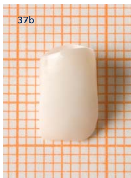
Abb. 37: Der überdimensionierte Grünling aus Zirkonoxid (Lava™, 3M Espe) in gefrästem und ungesintertem Zustand (37a) und das fertig gesinterte Kronengerüst (37b).
