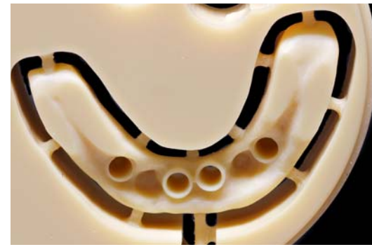
Abb. 19: ... mittels eines zahnfarbenen PMMA-Blanks
