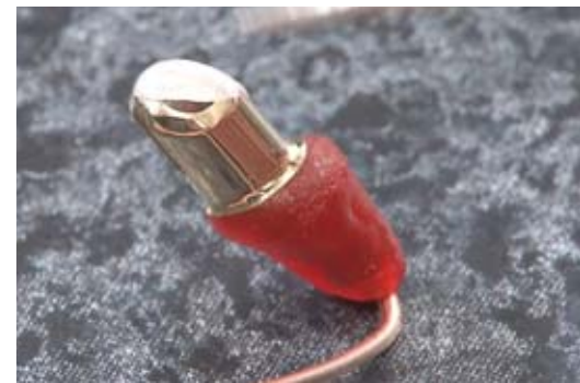
Abb. 28: Der Schraubenkanal wird ausgeblockt und das Primärteil mit Silberleitlack beschichtet, damit es auch im ausgeblockten Bereich zu einer Goldabscheidung kommt.
