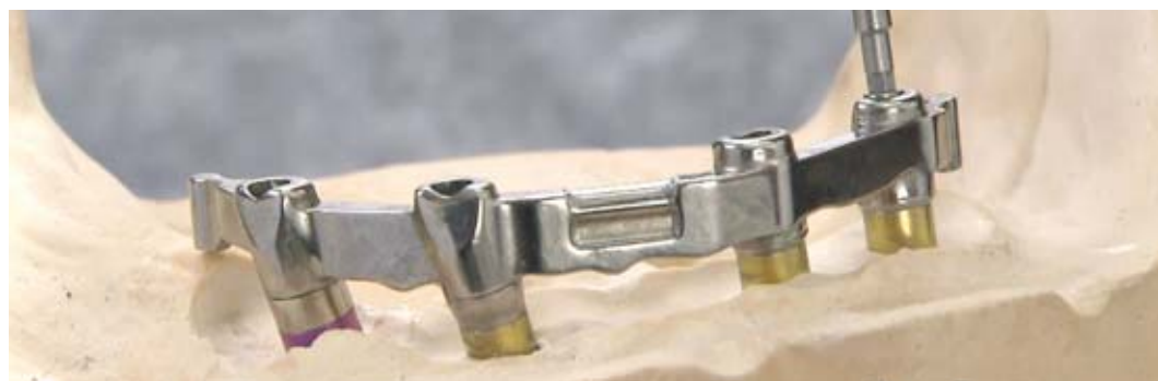
Abb. 35: Die Passung des ebenfalls extern gefertigten Stegs wird auf dem Meistermodell mit dem Sheffield-Test überprüft: Mit jeweils einer angezogenen Schraube sitzt der Steg spannungsfrei auf den anderen Abutments.
