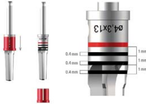
Abb. 8: Der Formbohrer besitzt einen optionalen Tiefenstopp, mit dessen Hilfe die Implantatschulter 0,4 mm suprakrestal zu liegen kommt. Für eine eventuell gewünschte abweichende Insertionstiefe sind zusätzliche Lasermarkierungen angebracht.
