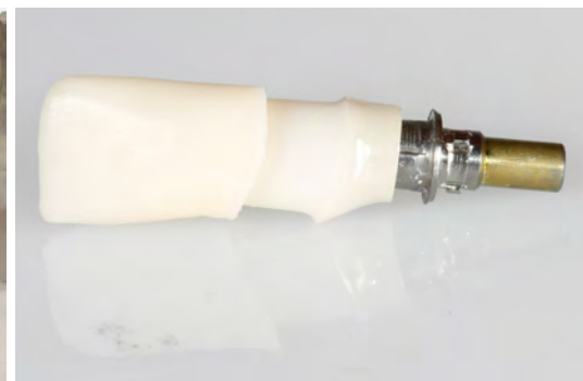
Abb. 28: Die Abutments und die Kronengerüste wurden in Zirkoniumdioxid umgesetzt.
