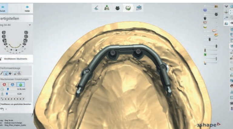
Abb. 1: Konstruktion des Steges in der CAD-Software.
