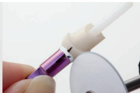
Abb. 11: Sorgfältige Überarbeitung der Klebefuge nach der Aushärtung mit einem abrasiven Gummierer.
