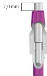
Die Halteschraube ragt bei eingestecktem Abformpfosten ca. 2 mm aus diesem heraus.
