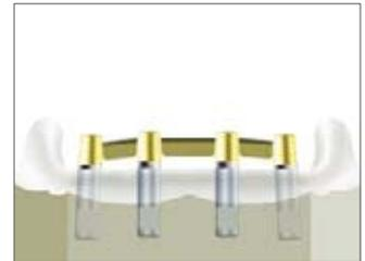
Stegbasen mit eingepassten konfektionierten Stegsegmenten aus anlötbarer Goldlegierung
