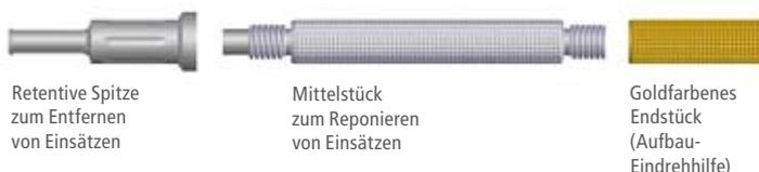
Um einen Verarbeitungs- oder Retentionseinsatz in das Retentionsgehäuse einzubringen wird das Mittelstück des Locator® Instruments verwendet. Hierfür wird die Spitze abgeschraubt. Auf das nun sichtbare Ende wird der gewünschte Einsatz aufgesteckt und in das Retentionsgehäuse vollständig eingedrückt. Das goldfarbene Endstück ist ebenfalls abschraubbar und kann als Eindrehhilfe für den CONELOG® Locator® Aufbau verwendet werden.
