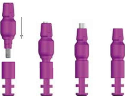
Die Komponenten werden in die Repositionshilfen reponiert. Dabei ist auf korrektes Einrasten der Rillen in die Repositionshilfe zu achten. Keinen Kleber verwenden!
