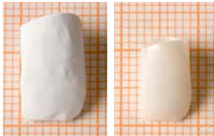
Abb. 37: Der überdimensionierte Grünling aus Zirkonoxid (Lava™, 3M Espe) in gefrästem und ungesintertem Zustand und das fertig gesinterte Kronengerüst.
