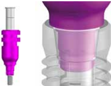
Abb. 24: Abformpfosten für die offene Abformung mit den für CONELOG® typischen drei Nocken, die in die Nuten der Innenkonfiguration greifen. Die Konusfläche des Implantates wird bei der Abformung nicht genutzt, um Höhenversatz auszuschließen. Die Implantatschulter dient als Höhenreferenz.
