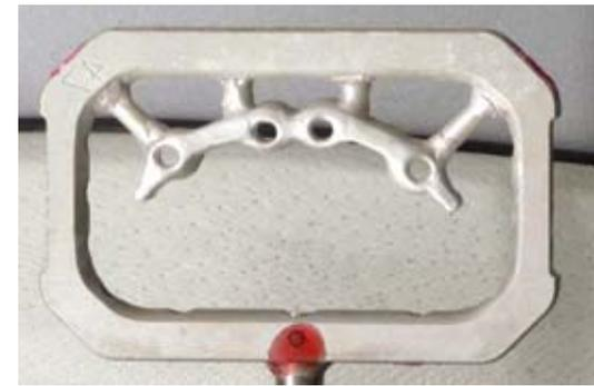
**Abb. 51:** Die Wachsmodellation wird lasergescannt und anschließend die Frässtrategie berechnet
