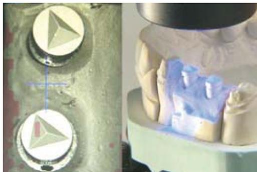
**Abb. 18:** Die durch die Scankörper definierten Implantatpositionen werden mit dem Streifenlicht-Scanner in die CAD-Software übertragen.
