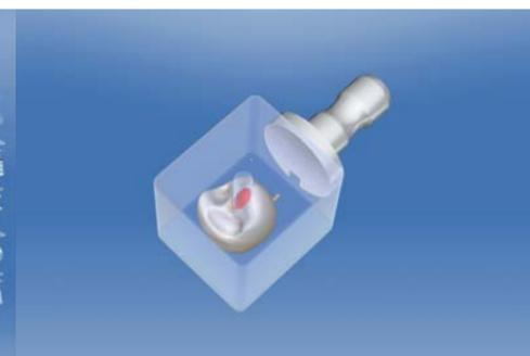
**Abb. 15:** Das Kronendesign wurde zum Fräsen optimal im Rohling positioniert.
