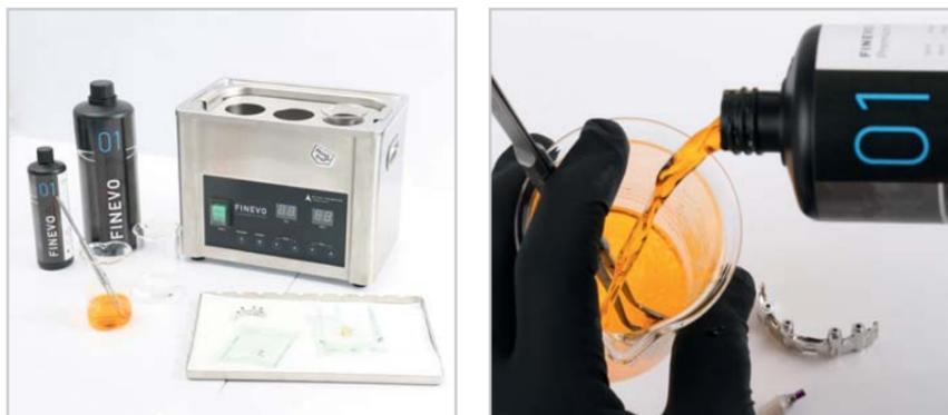
Abb. 10 und 11: Standardisiertes dreistufiges Reinigungsverfahren mit einem Waschprotokoll im Ultraschallbad.
