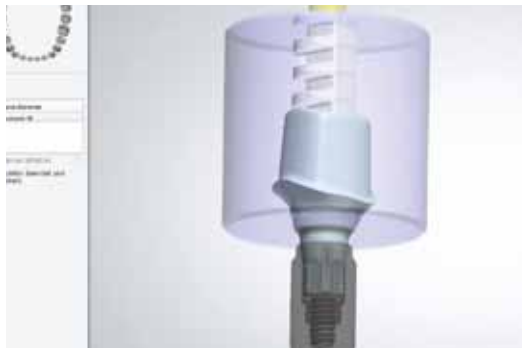
Abb. 22: Der Fräszylinder wird eingblendet und die Positionierung des Abutments geprüft.
