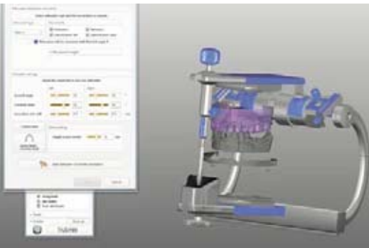
Abb. 10: Im virtuellen Artikulator werden alle Parameter vom realen Artikulator übernommen. So können bei der Kauflächengestaltung exakte Bewegungen abgefahren werden.
