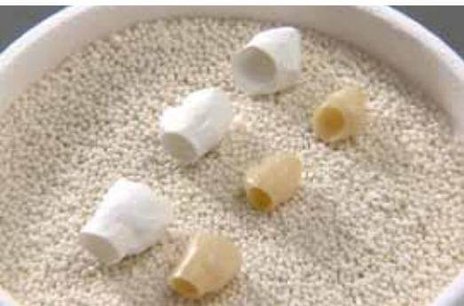
**Abb. 36:** Die ungesinterten und gesinterten Zirkonoxidkappchen im Vergleich: Die zuvor eingefärbte Keramik ist kontrolliert geschrumpft.
